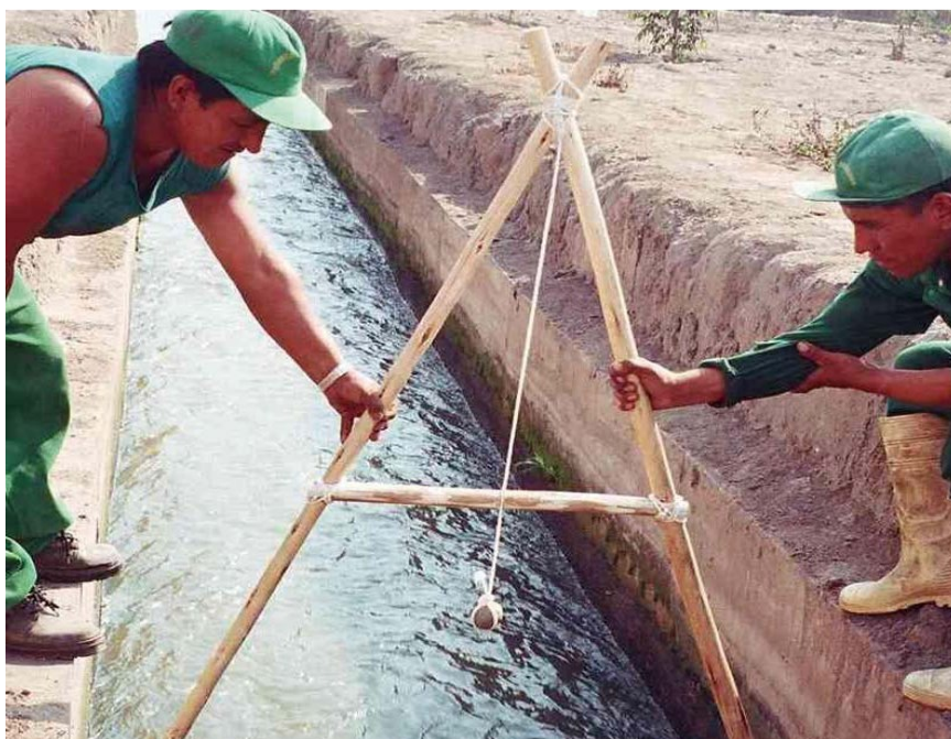
Fig 7 Aplicando el yakuapana o nivel andino.
